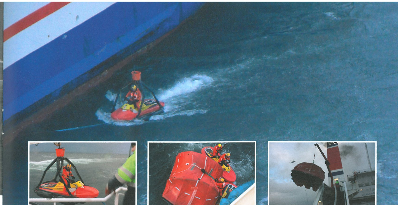
2. En CRRB sjösätts med hjälp av en vagg som är öppen i båda ändar. ▶
