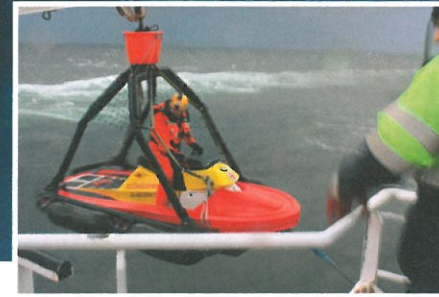
2. En CRRB sjösätts med hjälp av en vagg som är öppen i båda ändar. ▶
