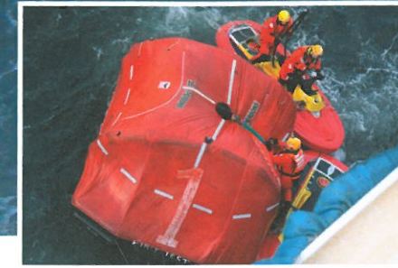
3. CRRB:n kopplar krankroken till flottens lyftstropp. Flottarna får inte vara för stora, max 50 personer, och måste ha en tillräckligt stark lyftögla för att kunna lyftas lastade. ▶
