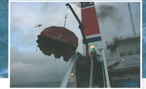
4. Flotten spelas hem av kranen och lyfts i säkerhet ombord. Om en 50-mannaflotte lyfts var sjätte minut innebär det 500 räddade i timmen. 5. CRRB:n lyfts ombord igen med hjälp av vaggan (stora bilden ovan).
